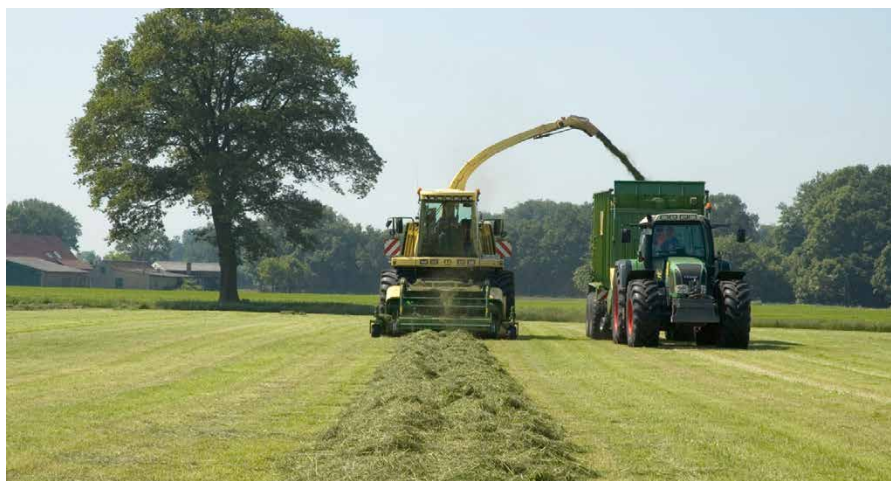
Je trockener das Gras ist, desto kürzer muss es für eine ausreichende Verdichtung geschnitten bzw. gehäckselt sein, um noch ausreichend verdichtet werden zu können. Insbesondere dann bietet der Einsatz von Felbhäckslern Vorteile.
