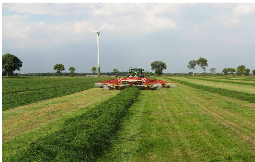
Um eine hohe Bergeleistung zu erreichen, sollte das Gras in ausreichend großen, lockeren und nicht verdrehten Schwaden abgelegt werden.
