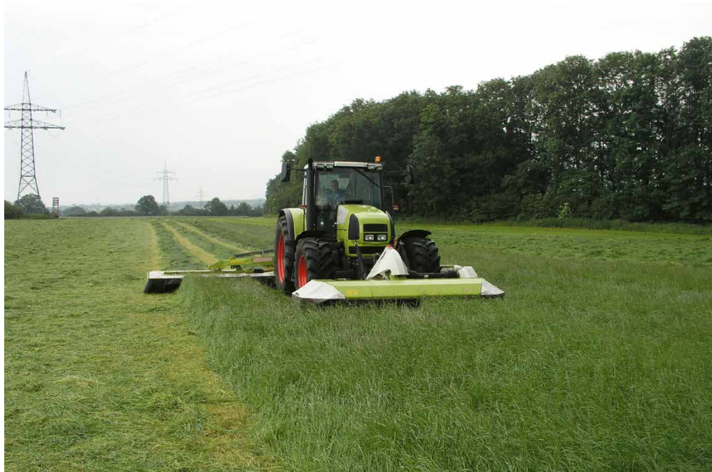
Die optimale Schnitthöhe für eine schmutzarme Silage beträgt bei Dauergrünland etwa 5 cm und bei Ackergras ca. 7 cm. Fotos: Fübbecker
