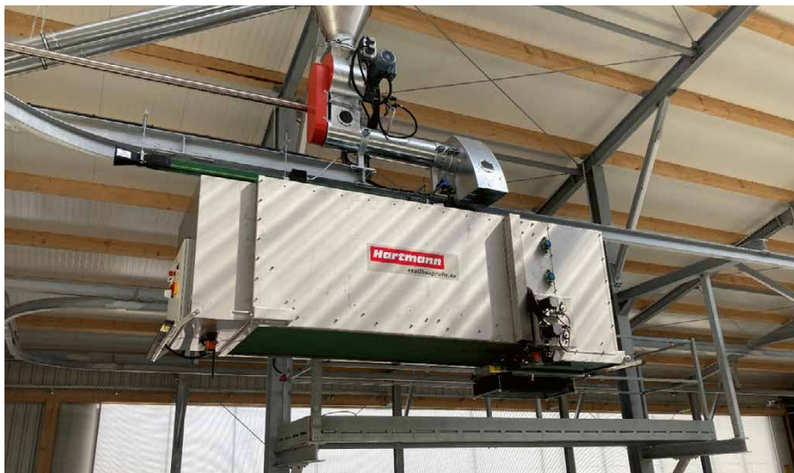
Der EinstreuMeister scannt die Liegeplätze von oben, so werden nur freie Liegeboxen eingestreut. Werkfoto
