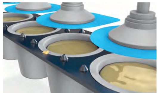
watttron erkennt Produktreste, doppelte oder fehlende Deckel direkt im Siegelprozess und sorgt so für maximale Prozesssicherheit.
