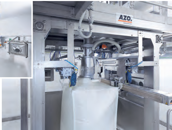
Hygienisch sichere Abfüllung des Milchpulvers in einen Big-Bag mit Verschweißvorrichtung.
