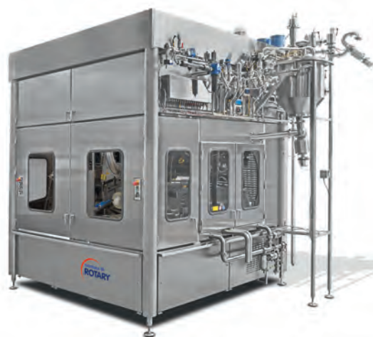
GRUNWALD-ROTARY XXL in Ultra-Clean-Ausführung. 1- bis 2-bahniger Eimerfüller zur Abfüllung von Milchprodukten in 1-, 5- und 10-l-Eimer.
