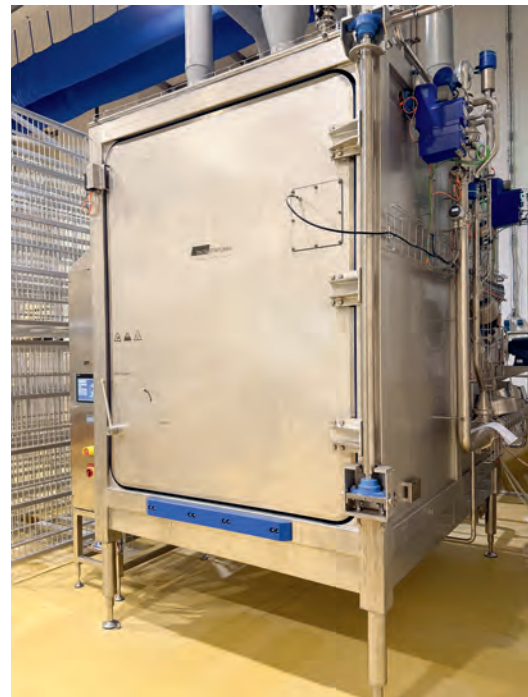
Reinigungskabine für Reifegestelle, Bretter und Zubehör – effizient, schonend und hygienisch.
