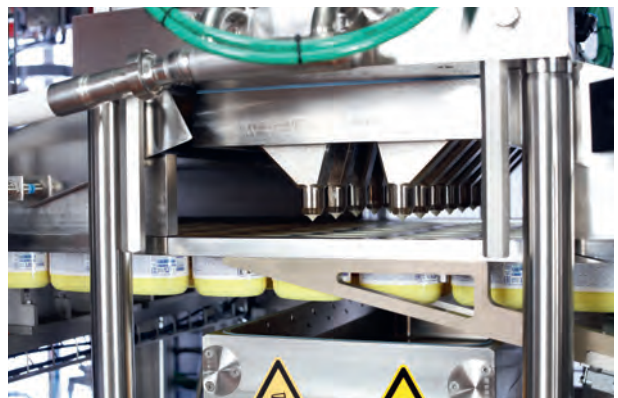
IMA Hassia C500, FFS Maschine für Becher, Abfüllstation.
